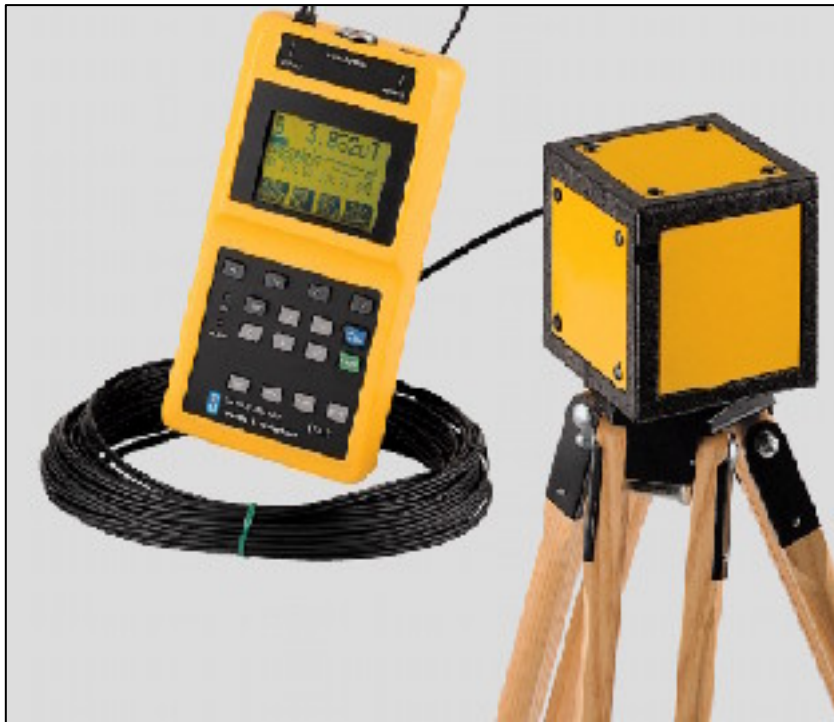
Bild 3: E- Sonde für elektrische Felder in 3 Achsen, Ex, Ey, Ez
