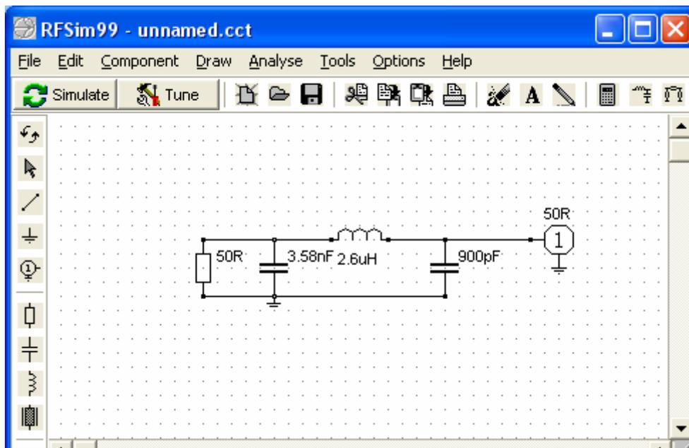
**Bild 10. Simulation des Pi – Filters nach Beispiel 2.4**
