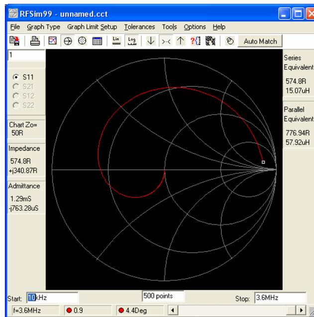
**Bild 11. Ausgangsimpedanzverlauf des Pi-Filters nach Beispiel 2.4**
