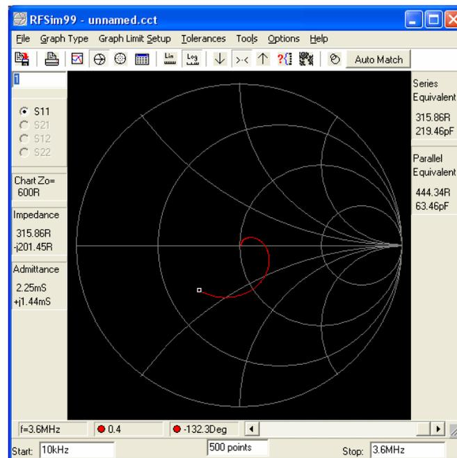
**Bild 9. Die gesuchte Antennenimpedanz (Marker) nach Beispiel 2.3**
