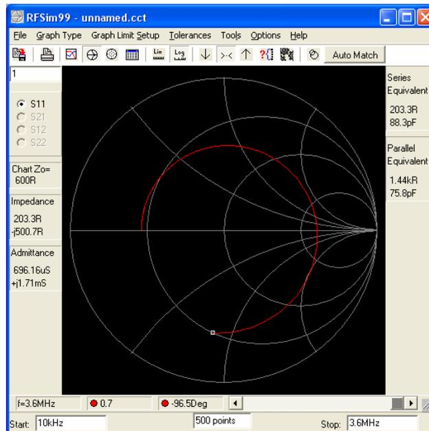
**Bild 14: Smith Diagramm der Simulation nach Beispiel 3.1**
