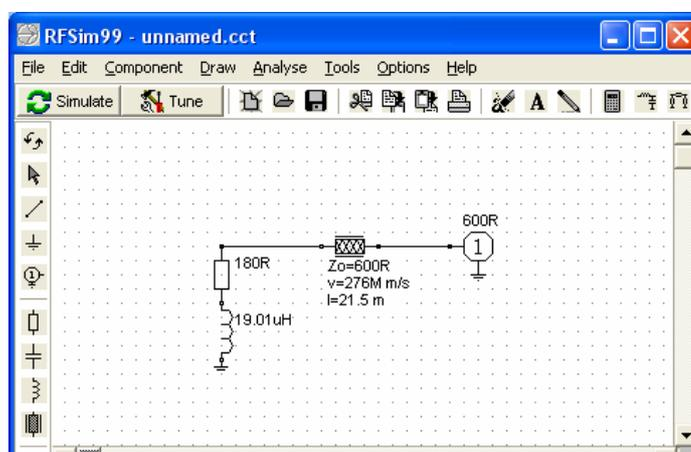
Bild 13: Simulation der Leitung nach Beispiel 3.1
