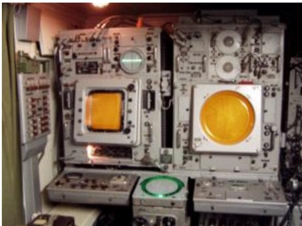
**Bild 1: Russisches Radargerät mit Goniometer (grüner Ring)**
