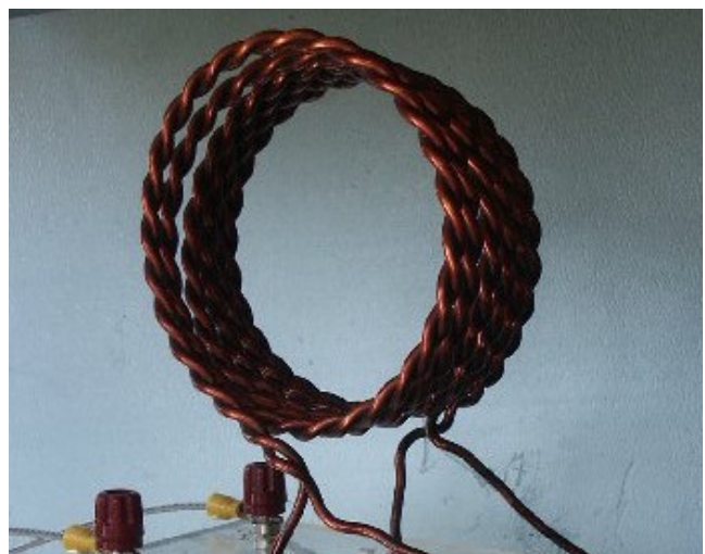
Bild 13: Einfache Ausführung eines Luft-Übertragers am Eingang einer Zweidrahtleitung
